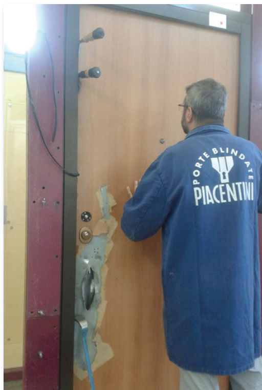
Antieffrazione: prova attacco manuale.
