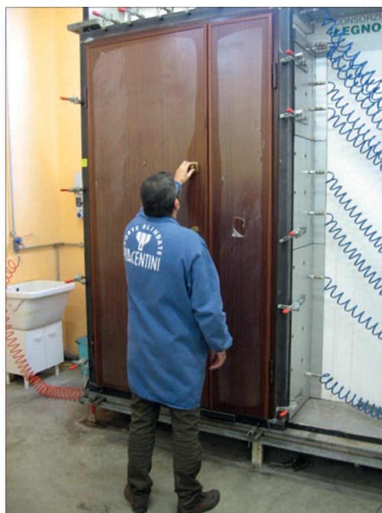
Prove: permeabilità all'aria; tenuta all'acqua; resistenza al vento.
