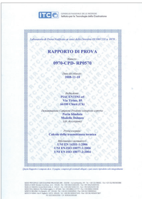
Trasmittanza termica 1,49 W/m 2 K.
