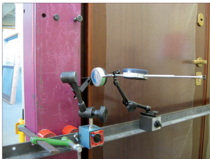
Antieffrazione: prova sotto carico statico.
